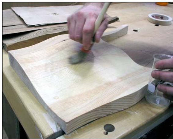
Figur 1. Förlimning av blindträ. Foto: Helén Johansson
